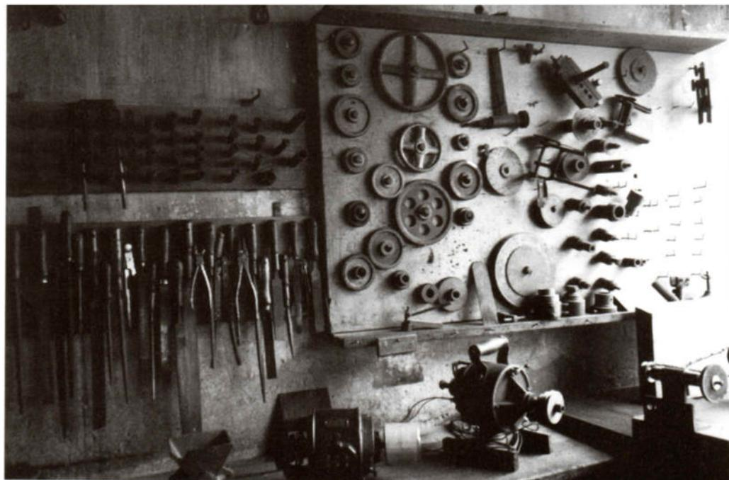
des Raumes befestigten Wellen, Bänder und Transmissionsriemen, die die Maschinen antreiben, in Schwung. Jetzt kann gedreht, gefräst, gehobelt und geschliffen werden, und es entsteht der Eindruck, als wäre gerade gestern noch hier eifrig gewerkelt worden.
