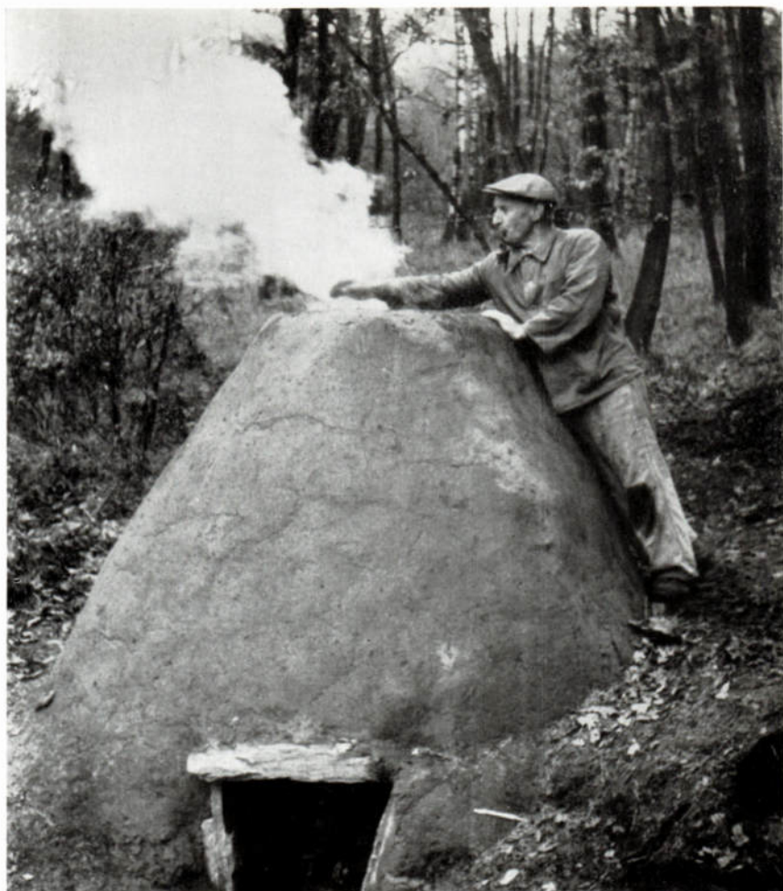
Abb. 27 Probeschmelze in einem rekonstruierten Rennofen bei Niederschelderhütte im Siegerland
